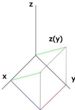
Supposons un coin – un pavé droit coupé en deux dans le sens de la diagonale. Dans le sens de  $x$  et  $y$ , la distance entre l'axe et le bord du coin est constante. Dans le sens de  $z$ , elle est donnée par  $z(y) = 3y$ .
